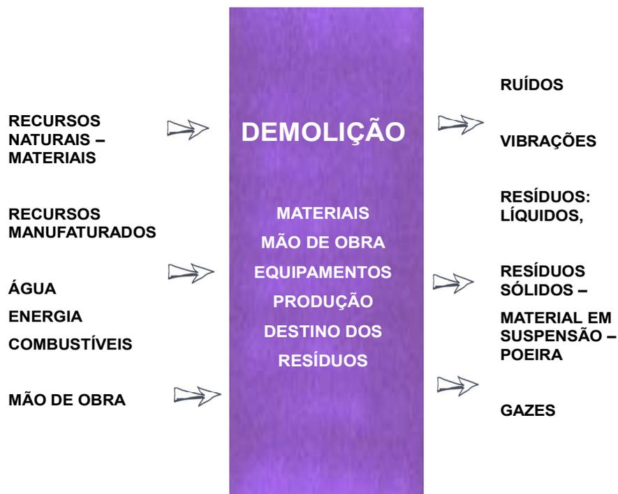
Figura 2:20 A demolição no ciclo de vida dos edifícios.<sup>50</sup>
