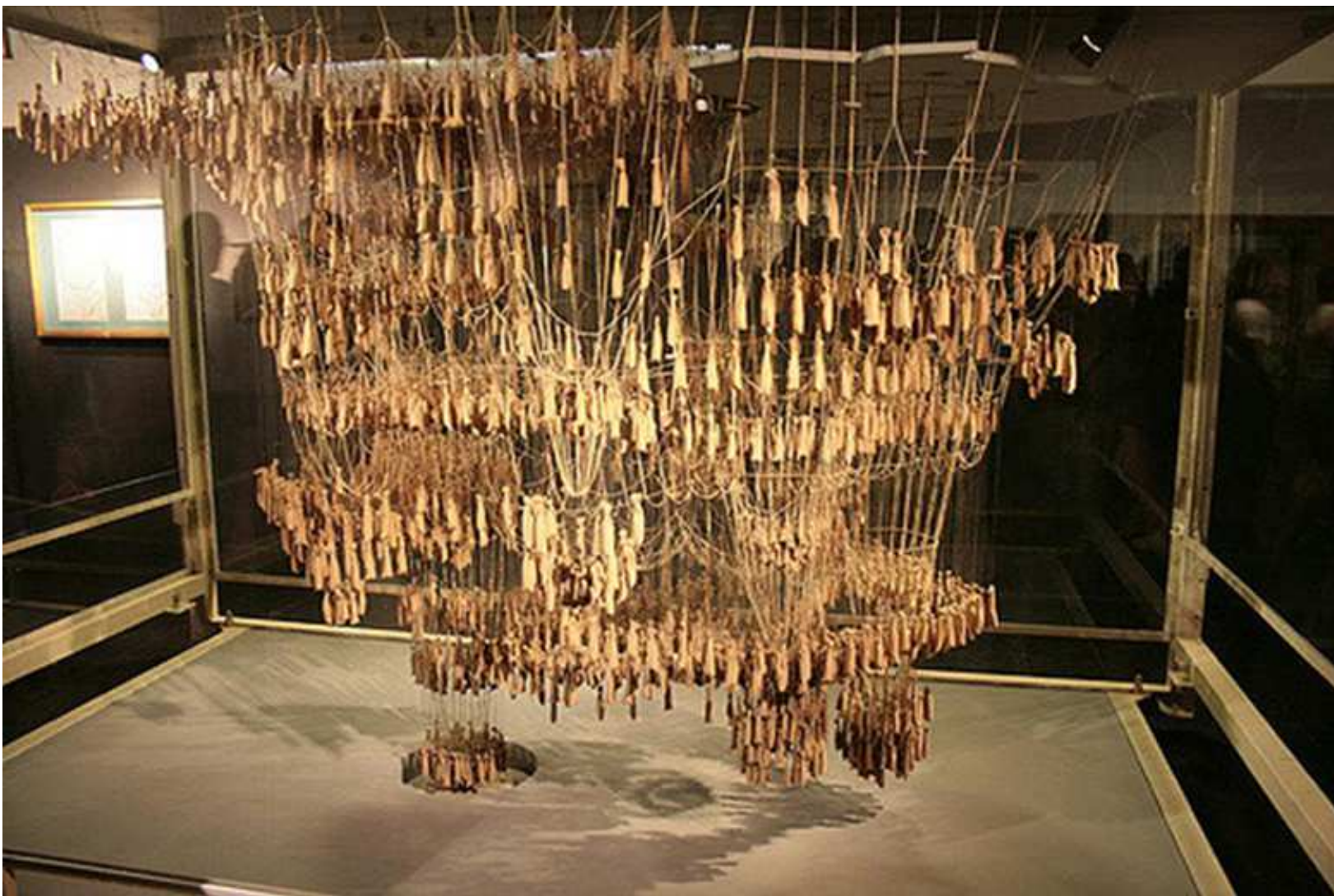
Modelo feito por Gaudí para encontrar as catenárias da Sagrada Família. Fonte: FLICKR. Disponível em: https://www.flickr.com/photos/scottcphtoroma/2919253381
