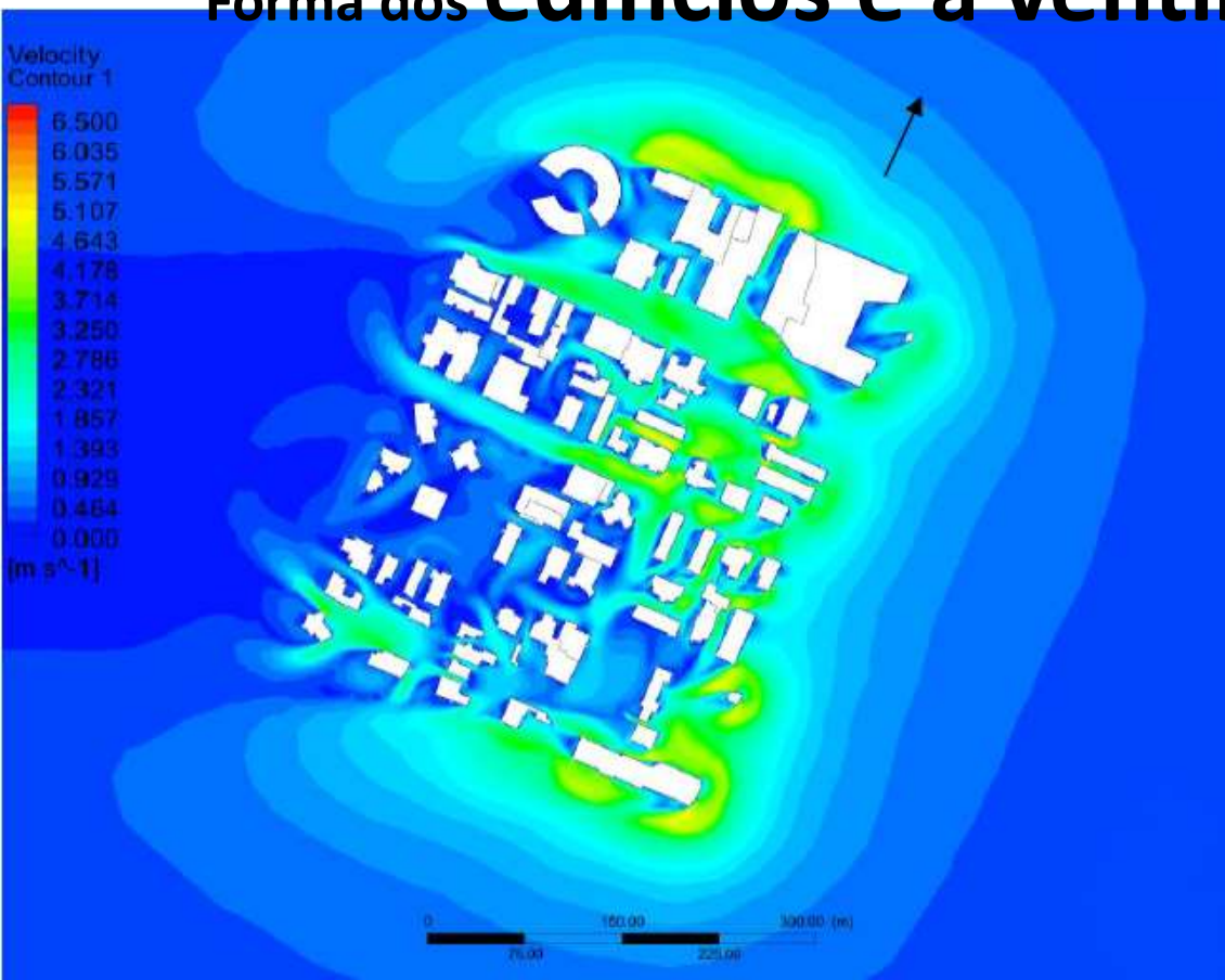
Figura 109: Fluxo do ar plano horizontal a 1,50 m do solo - Meireles Fonte: Elaborado pelo autor
